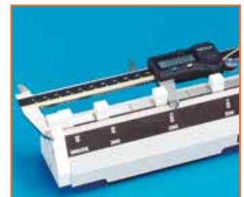
Nauwkeurigheid van schuifmaat controleren (buitenmeting)
