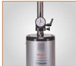
Kalibratie met analoge meetklok
