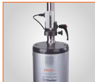
Inspectie met lineaire meter
